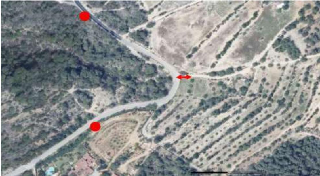
Ilustración 52. Puntos propuestos para señalización provisional de "salida de camiones" durante la obra.
