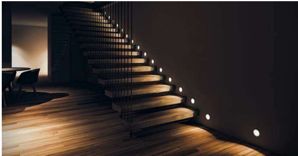
Imagen 14. Iluminación de escalera con bañadores de superficie empotrados.
